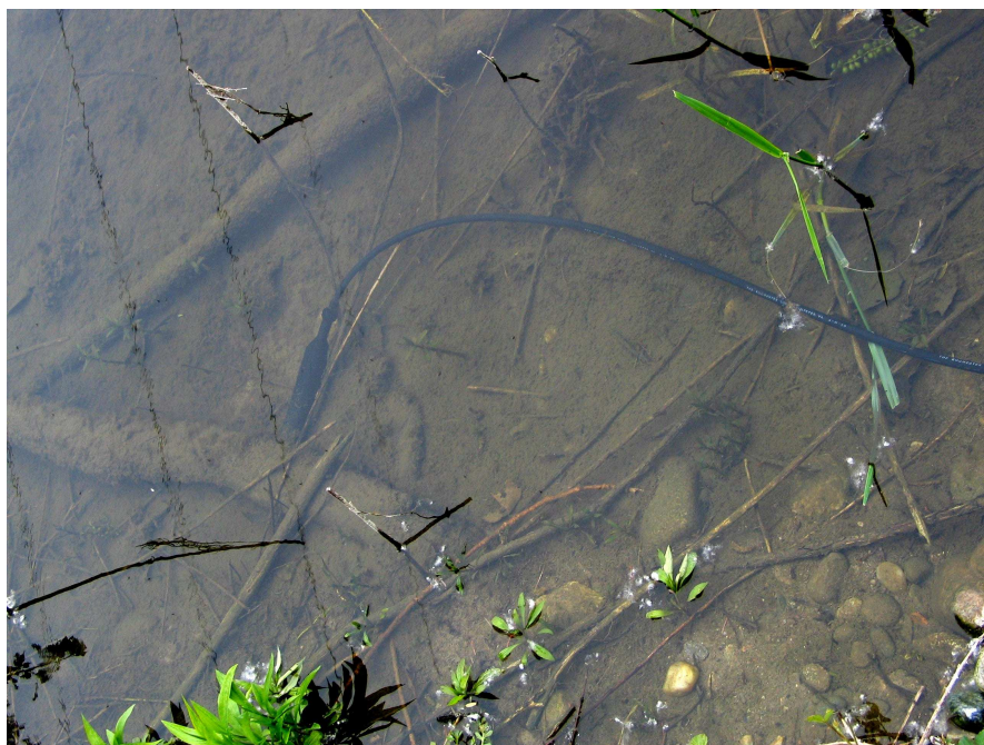
Fig. 4 - Idrofono ITC posizionato sul fondo in acque basse.
